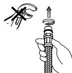
**I** Non serrare con utensili. Avvitare i raccordi con tenuta OR a mano fino a percepire una battuta meccanica.
